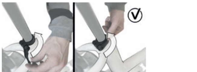
Abbildung 8: Schließen des Schnellspanners der Sattelstütze
