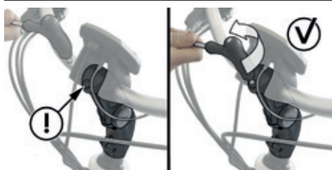
Afbeelding 9: De bout op de stuurpen losdraaien
