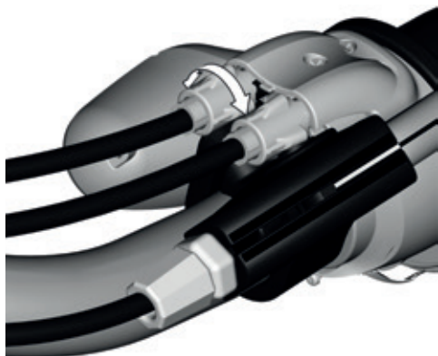
Image 41 : Réduire ou augmenter le jeu du câble en tournant le cylindre sur la poignée de changement de vitesses
