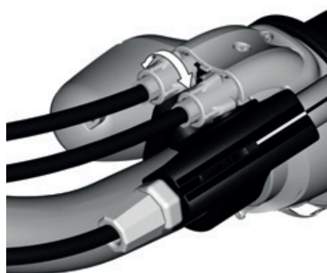
Abbildung 41: Reduzierung oder Erhöhung des Kabelspiels durch Drehen der Zuginstellschraube am Griffschalter
