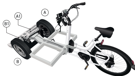
Image 32 : Dépose et pose d'un pneu avant
