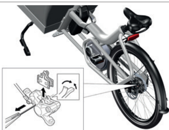
Abbildung 39: Entfernen der Bremsbeläge, um sie auf Verschleiß zu prüfen
