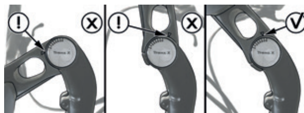
Image 11 : Rester dans la plage indiquée sur le côté de la potence
