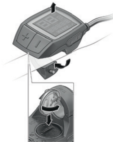
Abbildung 30: Wechseln der Knopfzellen im Purion-Display
