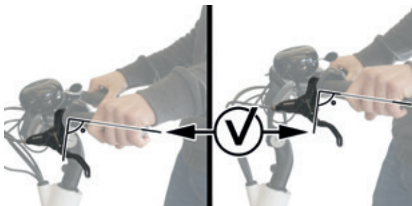
Image 12 : Corriger l'angle du levier de frein pour les différentes positions de la potence
