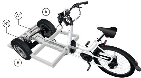
Afbeelding 32: Een voorband verwijderen en aanbrengen
