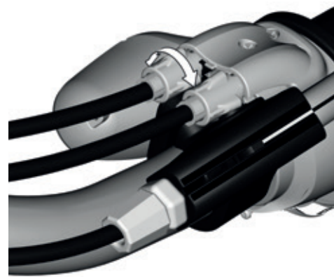
Afbeelding 41: Verminderen of vergroten van de speling van de kabel door de bus aan de draaiversteller te draaien
