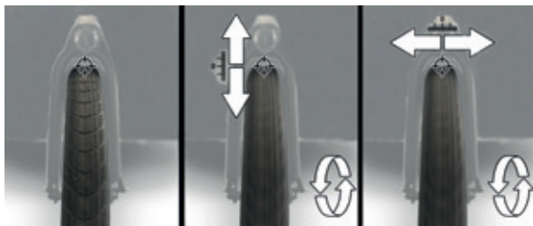
Image 34 : Vérifier le voile de la roue arrière
