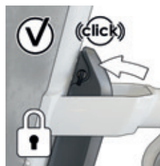
Afbeelding 18: Terugmelding juist geplaatste accu
