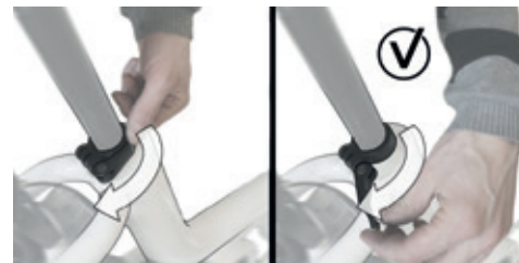
Abbildung 6: Öffnen des Schnellspanners der Sattelstütze
