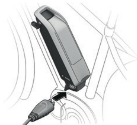
Abbildung 28: Einstecken des Ladegerätsteckers in die Ladebuchse am unteren Teil der Akkuhalterung
