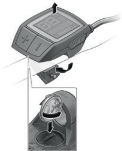
Afbeelding 30: De batterijen van het Purion display vervangen
