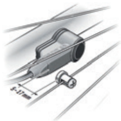
Afbeelding 31: Afstand tussen de snelheidssensor en de magneet van de snelheidssensor
