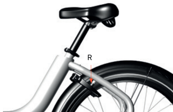
Afbeelding 38: De slotrubbers controleren
