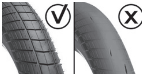
Image 33 : Usure des pneus avant et arrière
