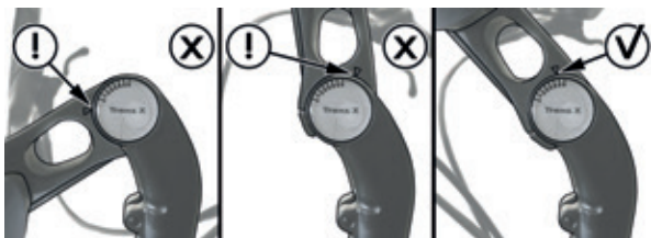
Abbildung 11: Bleiben Sie innerhalb des Bereichs, der auf der Seite des Vorbaus angeben ist.
