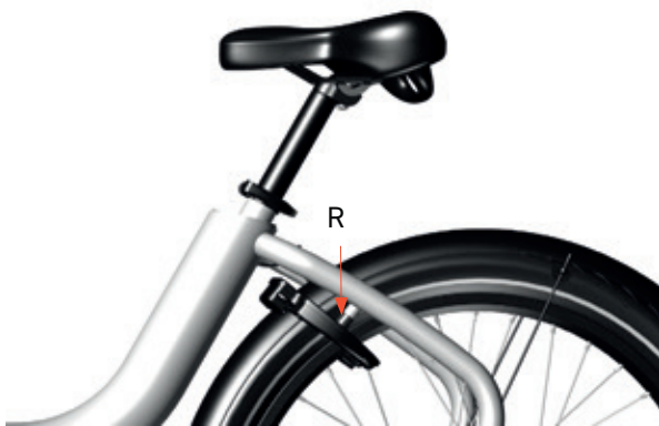
Image 38 : Vérification des caoutchoucs de verrouillage
