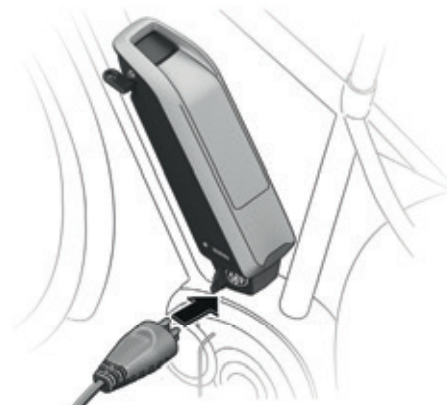
Afbeelding 28: Steek de laadstekker in de laadaansluiting op het onderste gedeelte van de accuhouder
