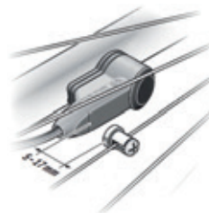
Image 31 : Distance entre le capteur de vitesse et l'aimant de rayon du capteur de vitesse
