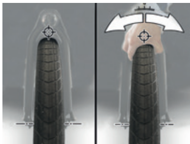
Image 36 : Vérifier le jeu sur l'axe du moyeu arrière
