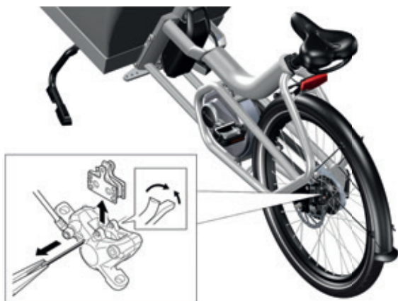
Afbeelding 39: Verwijderen van de remblokjes om ze op slijtage te controleren
