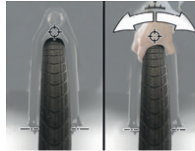
Abbildung 36: Überprüfung des Spiels der hinteren Nabenachse
