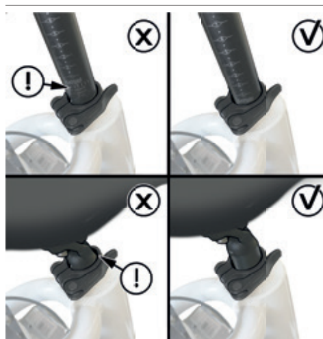
Afbeelding 7: Max en min insteeklengte van de zadelpen
