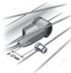
Abbildung 31: Abstand zwischen dem Geschwindigkeitssensor und dem Geschwindigkeitssensormagneten
