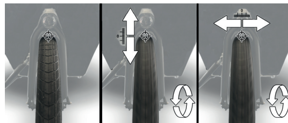
Image 34 : Vérification du décalage de la roue
