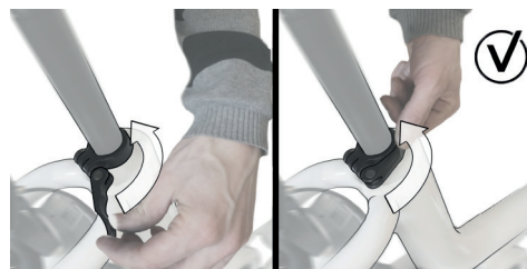
Abbildung 8: Schließen des Schnellspanners der Sattelstütze
