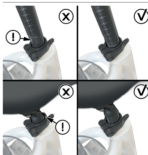
Abbildung 7: Maximale und minimale Einsetztiefe der Sattelstütze
