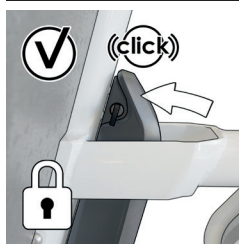
Image 18 : Batterie correctement installée
