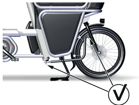
Abbildung 36: Prüfen des Lenkgestänges an den Kugelgelenken
