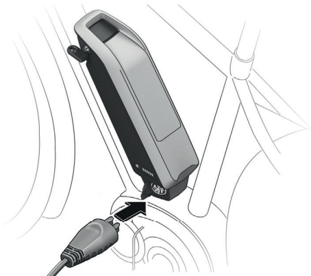
Abbildung 29: Einstecken des Ladegerätsteckers in die Ladebuchse am unteren Teil der Akkualterung
