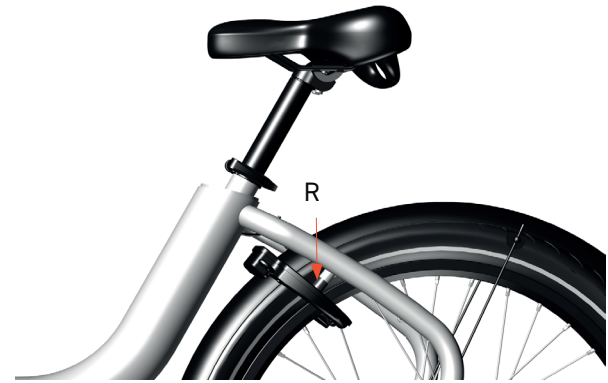
Image 37 : Vérification des caoutchoucs de verrouillage
