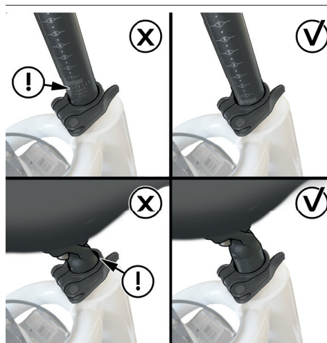
Afbeelding 7: Max en min insteeklengte van de zadelpen
