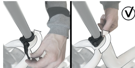
Abbildung 8: Schließen des Schnellspanners der Sattelstütze
