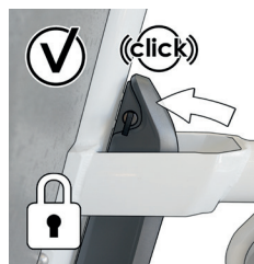
Image 18 : Batterie correctement installée
