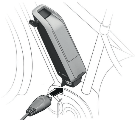
Abbildung 32: Einstecken des Ladegerätsteckers in die Ladebuchse am unteren Teil der Akkualterung
