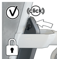
Abbildung 18: Klickgeräusch signalisiert ordnungsgemäß eingesetzten Akku
