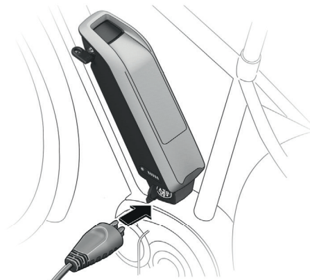
Image 32 : Branchement du chargeur dans la prise de charge sur la partie inférieure du support de batterie
