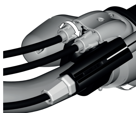
Abbildung 40: Reduzierung oder Erhöhung des Kabelspiels durch Drehen der Zuginstellschraube am Griffschalter
