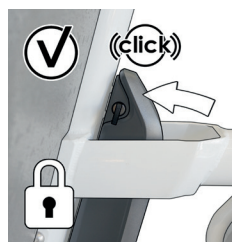
Image 18 : Batterie correctement installée
