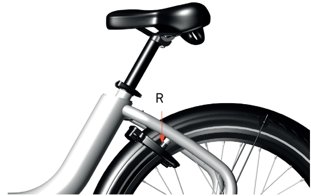
Afbeelding 37: De slotrubbers controleren
