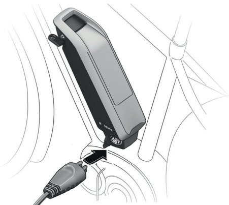
Afbeelding 29: Steek de laadstekker in de laadaansluiting op het onderste gedeelte van de accuhouder
