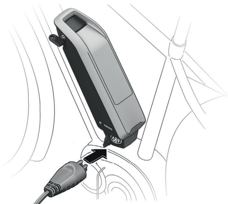
Image 29 : Branchement du chargeur dans la prise de charge sur la partie inférieure du support de batterie
